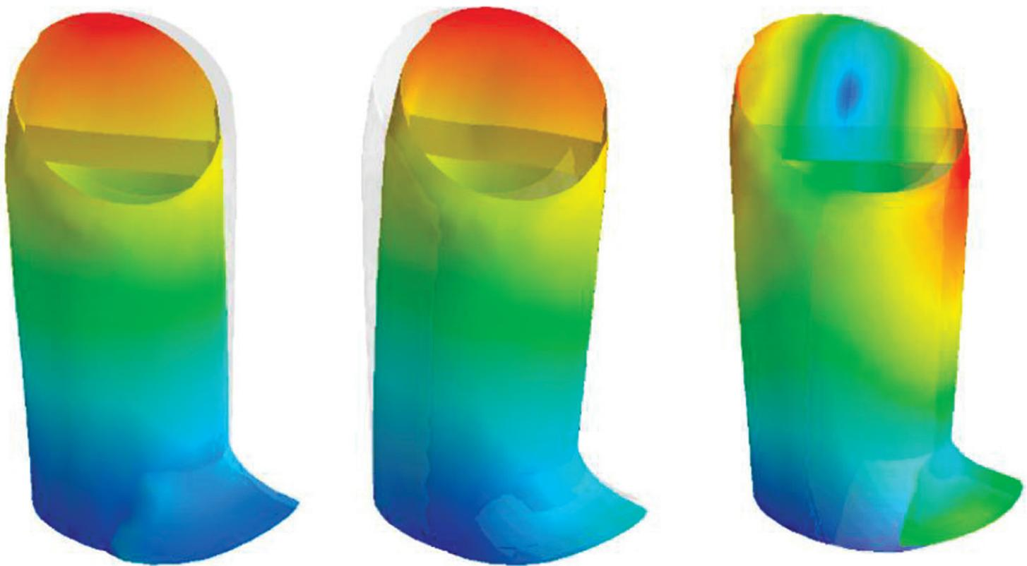
Fig. 14 | Primi tre modi strutturali utilizzati per le analisi dinamiche all'azione del vento.
